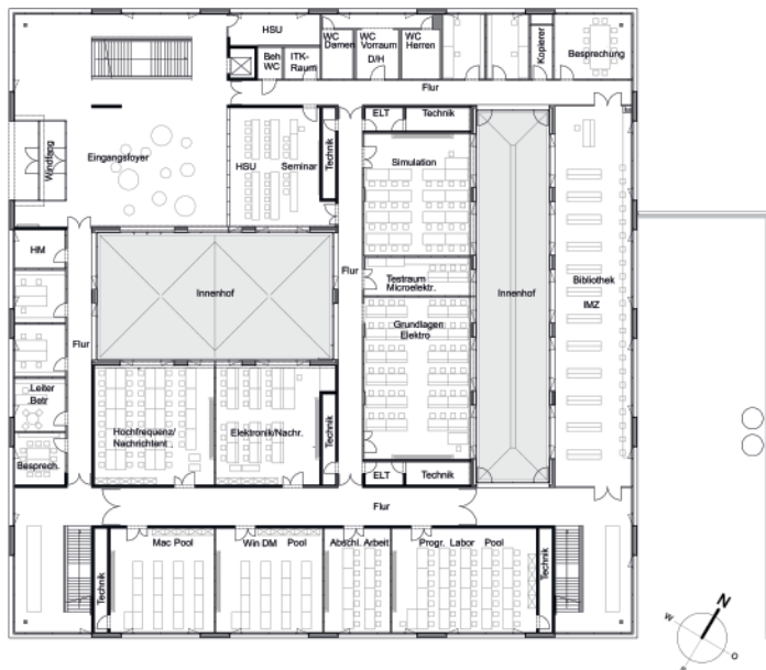
Abbildung 77: Erdgeschoss-Grundriss Plan: Vermögen und Bau BW
