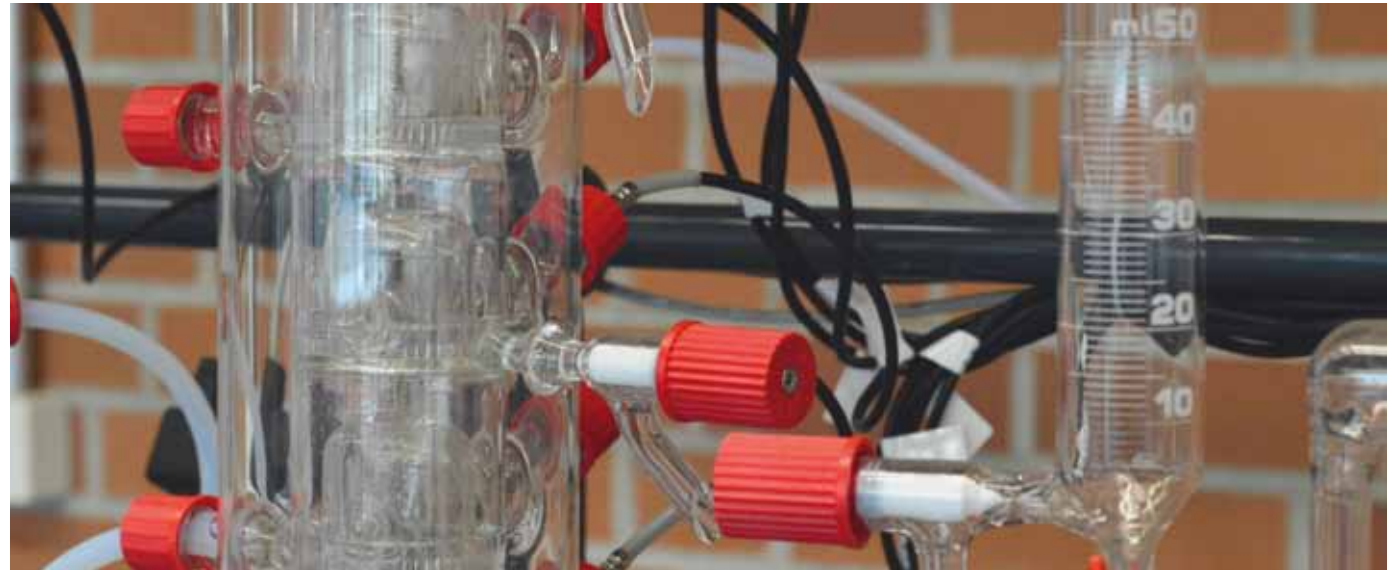
Detail einer Rektifikations-Kolonne zur Abtrennung von Ethanol aus einem Wasser-Ethanol-Gemisch (Foto: Re)
