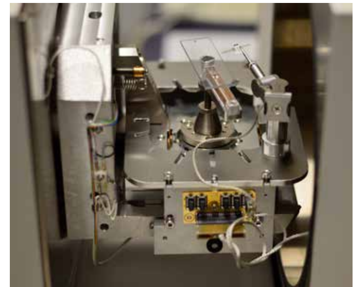
Ein Mikroroboter übernimmt die Haftkraftmessung (Foto: Re)
