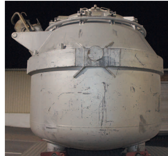
Außenaufnahme eines Transportbehälters für Flüssigaluminium (Foto: DS)
