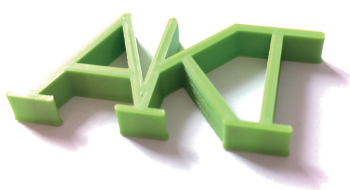
3D-Druck des AKT-Logos aus einem Biokunststoff
